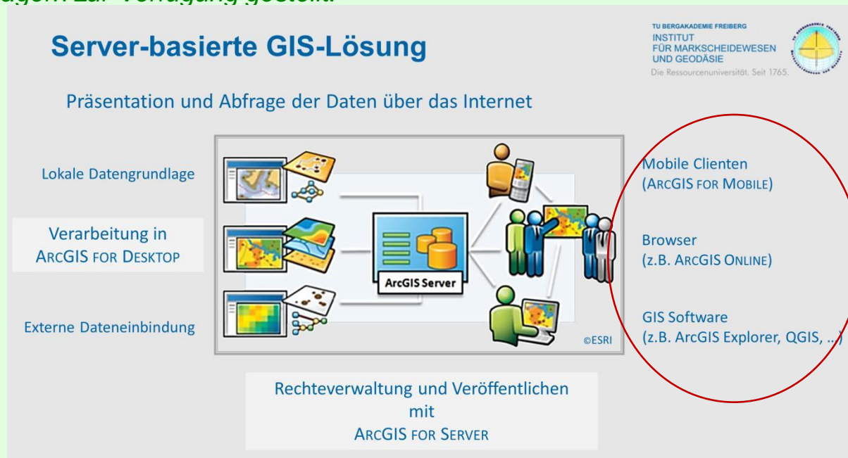
Abbildung 2: Schematische Darstellung der serverbasierten GIS-Lösung (TU Bergakademie Freiberg 2013)
